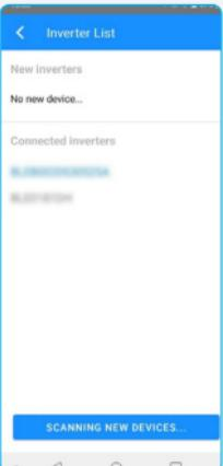
Pentru reusita conectarii trebuie introdusa seria invertorului, fie prin scanare, fie selectand Manual Connection si alegand echipamentul disponibil pe reteaua Bluetooth. (Seria produsului se gaseste pe eticheta produsului la sectiunea Serial Number).
