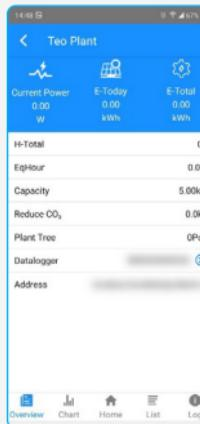
In cazul in care invertorul are un CT sau SmartMeter atasat, atunci va trebui introdusa seria invertorului si in ecranul Overview.
