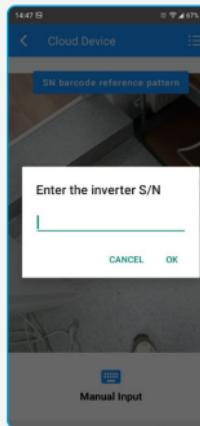
Se va cere introducerea S/N (Serial Number) a invertorului. Aceasta se poate face in doua feluri: fie se scanaza codul de bare aflat pe eticheta de pe invertor ori de pe ambalajul acestuia, fie se introduce manual (apasand butonul Manual Input aflat in partea de jos).
