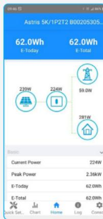
Se face configurarea modulului Wi-Fi prin accesarea butonului Quick Setup din partea de jos-stanga. Se urmeaza toate instructiunile aferente celor 3 pasi de configurare prealabila. Pentru aceasta trebuie introduce datele retelei wireless a proprietarului (SSID si parola de acces). Se urmareste ca LED-ul modulului WiFi sa-si schimbe culoarea din albastru in verde, semn ca modulul s-a conectat la reteaua WiFi.
