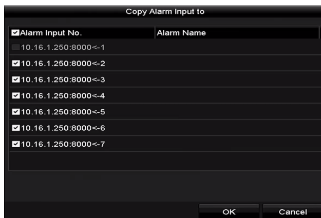
Figura 8–10 copierea setărilor intrării alarmei
