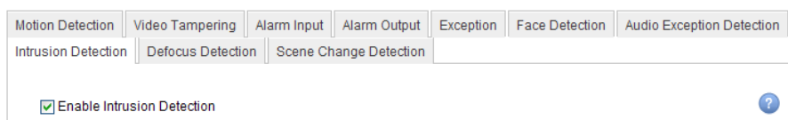
Figura 6–13 Configurare detectare intruziune pe cameră IP
